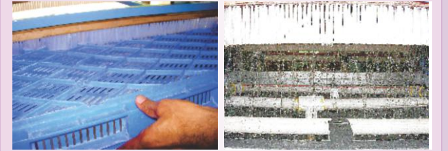
ತಟ್ಟೆಯಲ್ಲಿನ ಕೊಳೆ ತೆಗೆಯುವ ಮತ್ತು ಉಜ್ಜುವ ಬ್ರೂನ್ ತಟ್ಟೆ ತೊಳೆಯುವ ಘಟಕದಲ್ಲಿ ಹೆಚ್ಚು ಒತ್ತಡದಿಂದ ನೀರನ್ನು ಸಿಂಪಡಿಸುವ ಜೆಟ್
