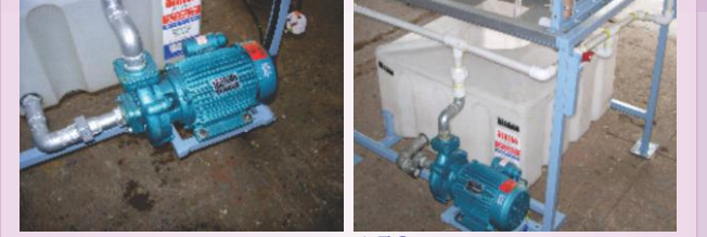
ಒಂದು ಅಶ್ವಶಕ್ತಿಯ ಹೆಚ್ಚು 150 ಲೀ. ಸಾಮರ್ಥ್ಯದ ಸೋಂಕು ಒತ್ತಡದಿಂದ ಹೊರ ಹಾಕುವ ಪಂಪ್ ನಿವಾರಕ ದ್ರಾವಣದ ತೊಟ್ಟಿ
